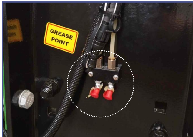
Mazací místa pro výtlačný konec se svislými rotory
