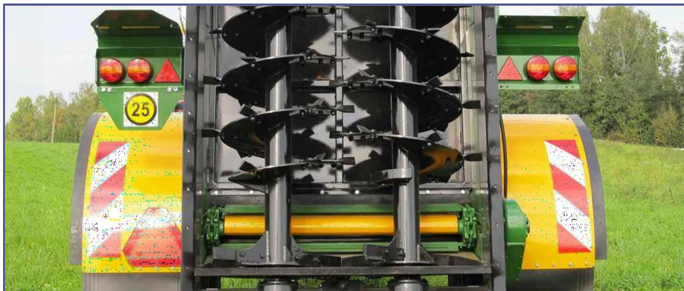
Spodní reduktor pro výtlačný konec se svislými rotory
