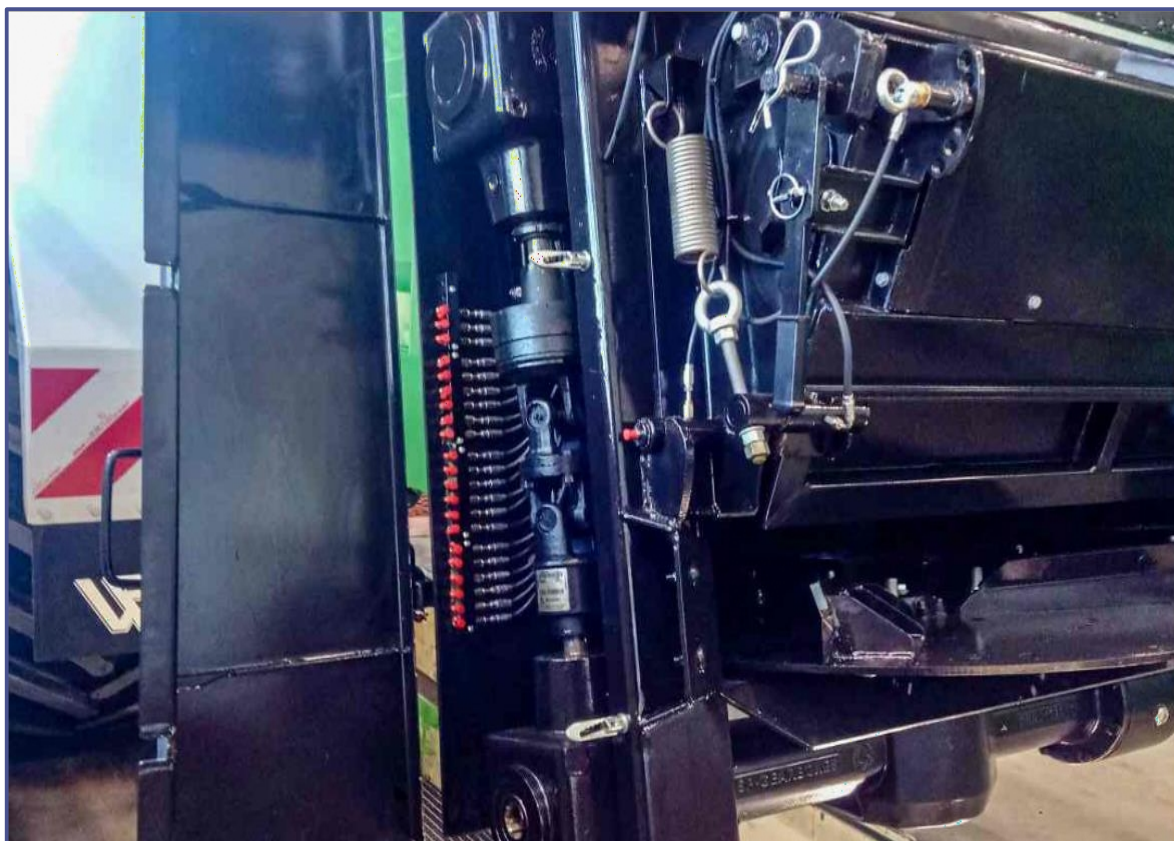
Mazací místa pro výtlačný konec s horizontálními rotory
