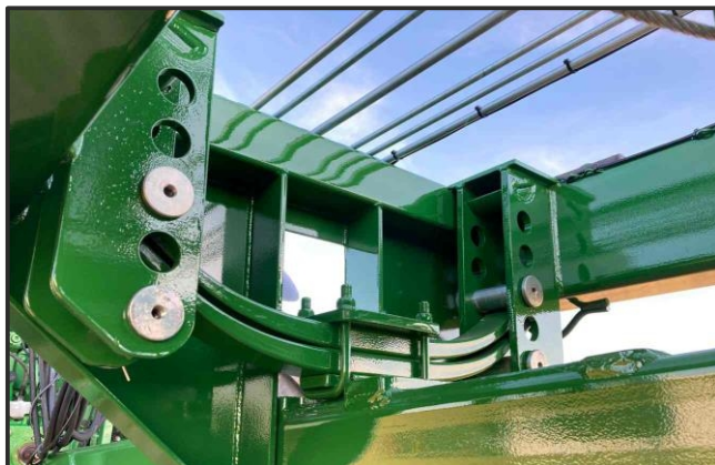
Nastavení výšky táhla příčné pružiny
