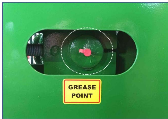
Mazání předních ozubených kol podlahového kola. dopravníku.
