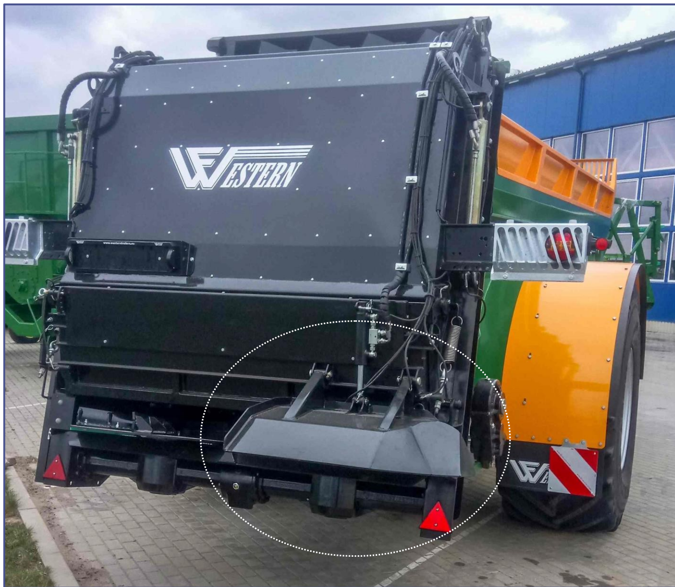
Systém "edge of field" je aktivován a kovový kryt je dole.
