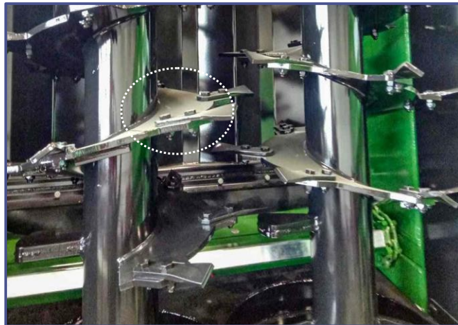
Lopatky na výtlačném konci jsou zajištěny šrouby.
