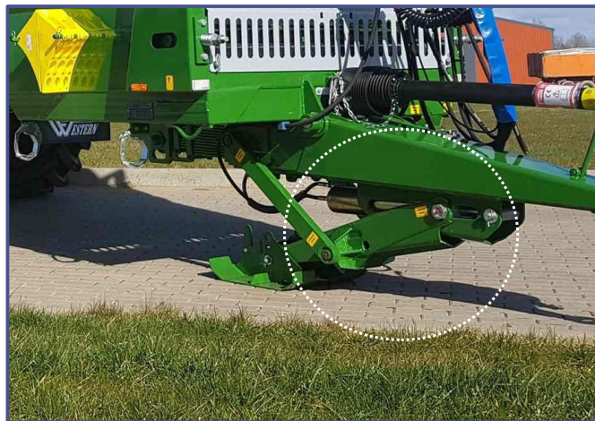
Mazací místa pro hydraulickou nohu a ruční brzdou rukojeť.
