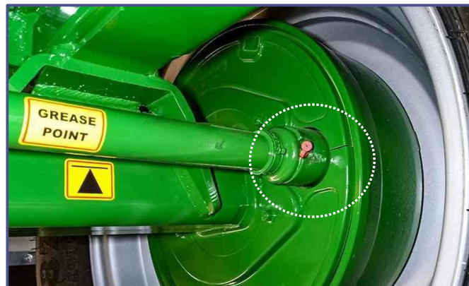
Mazací body nápravy, brzdové páky
