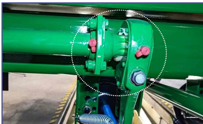
Mazací body nápravy, brzdové páky
