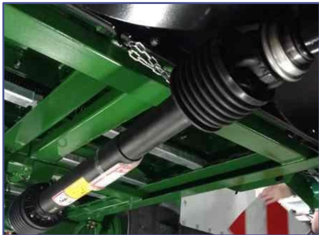
Vývodový hřídel je řádně připojen a zajištěn.
