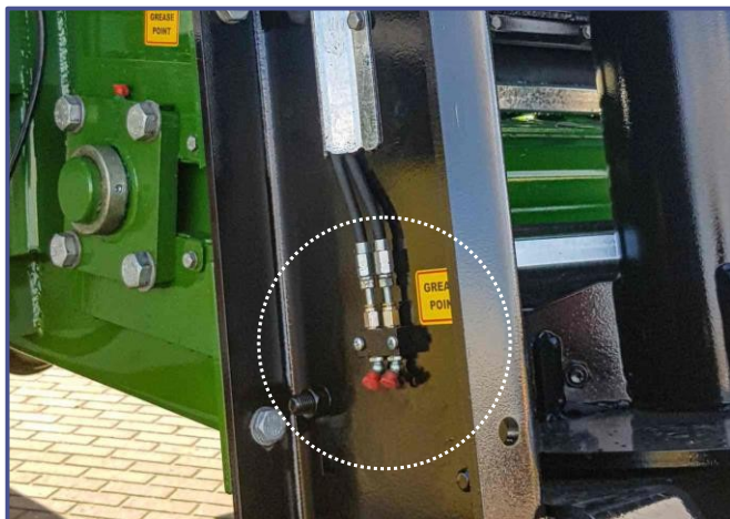
Mazací místa pro výtlačný konec se svislými rotory
